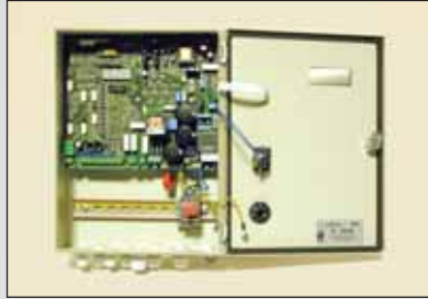
Torsteuerung TST FUE 2 – CG für Schnellauftor Typ SLT Professional und SLT-Premium 25/FS
